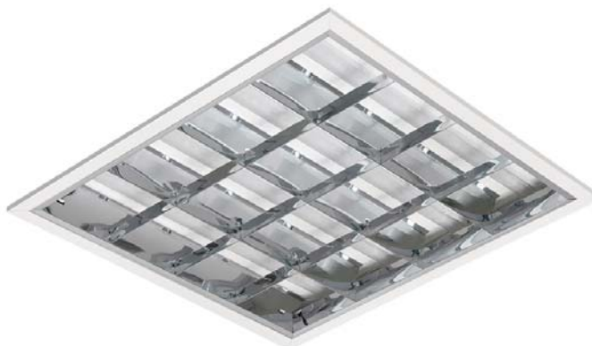
Figura 20 – luminária tipo calha de embutir para lâmpadas t5, corpo em chapa de aço pintada na cor branca microtexturizada, aletas parabólicas alto brilho. (EAA06-E)
